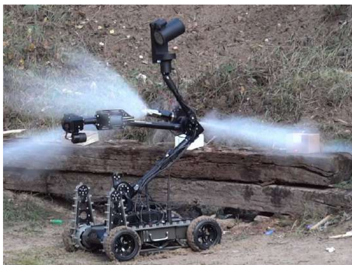
Rys. 5.1. Robot PIAP Gryf podczas wystrzeau z działka bezdrutowego
