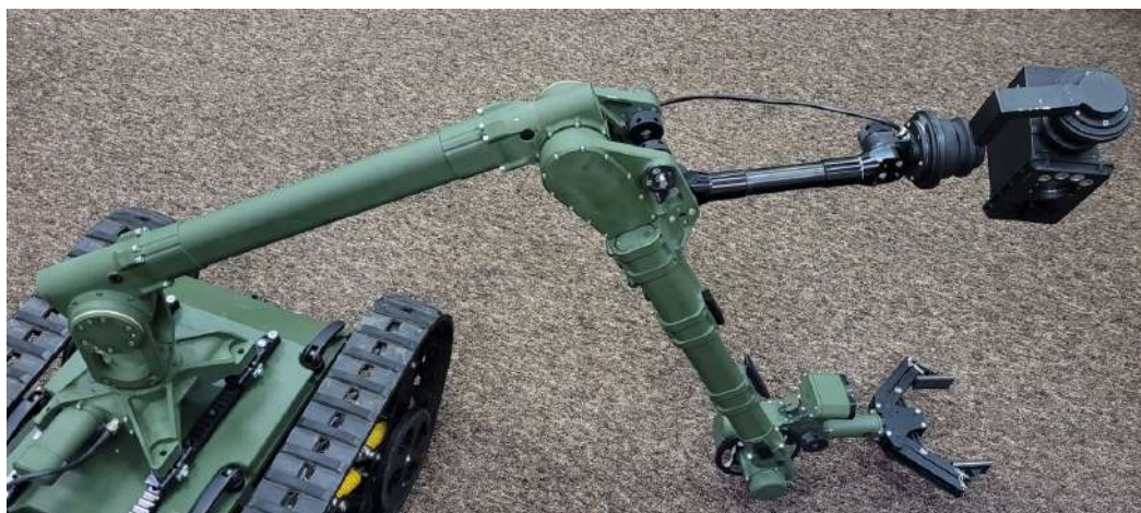
Rys. 6.5. Robot PIAP Patrol realizujący ruch przesuwania obiektu po podłodze
