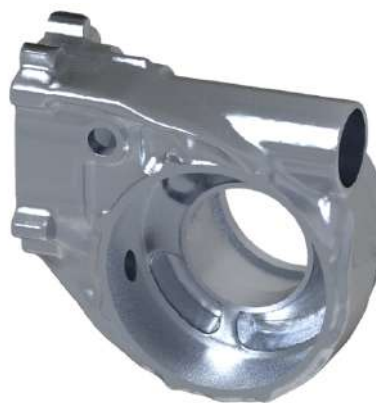
Rys. 7.20. TO z więzem rozformowania i minimalnym promieniem krzywizny 3mm. Masa wynikowa 480g. Czas obliczeń 27g 28min
