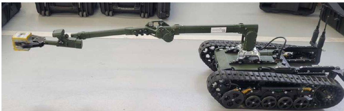
Rys. 8.25. Robot PIAP Patrol z zintegrowanym elementem wykonanym wg opracowanej metody: a - podczas badań terenowych, b - podczas testu udźwigu na maksymalnym wysięgu
